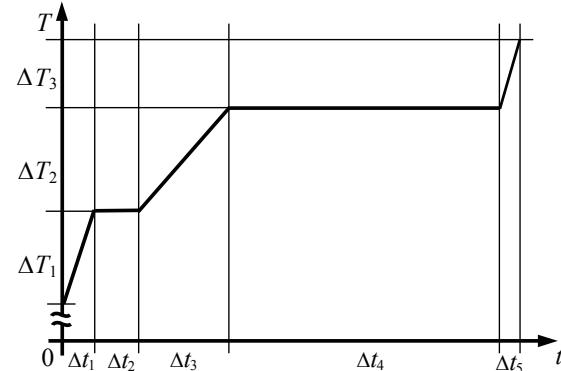
$$1) \frac{P \cdot \Delta t_1}{m \cdot \Delta T_1} \quad 2) \frac{P \cdot \Delta t_2}{m} \quad 3) \frac{P \cdot \Delta t_3}{m \cdot \Delta T_2} \quad 4) \frac{P \cdot \Delta t_4}{m}$$
