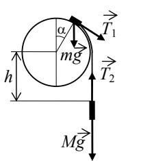
5. Груз  $m$  в точке отрыва ёщё движется по окружности радиусом  $R$ , но уже не давит на сферу. Поэтому его центростремительное ускорение вызвано только силой тяжести, так как сила  $\vec{T}_1$  направлена по касательной к сфере (см. рисунок):
